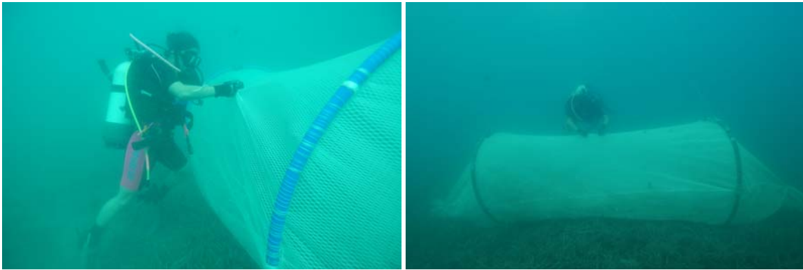
Şekil 4. Örtü-kafesin gözlemler için sualtına indirilmesi ve zeminde sabitlenmesi
