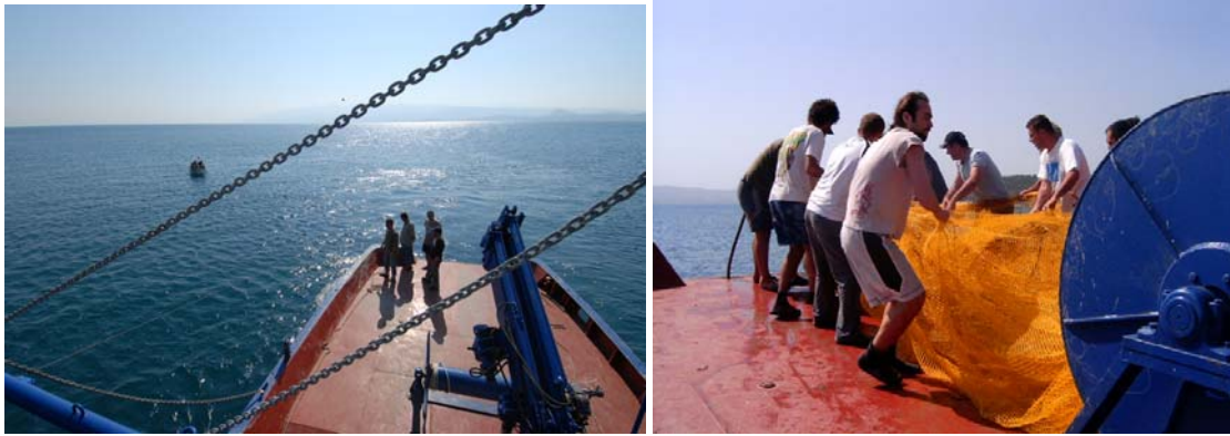
Şekil 2. Trol çekimlerinin yapıldığı EGESÜF R/V ve trol ağının ağ tamburuyla güverteye alınması
