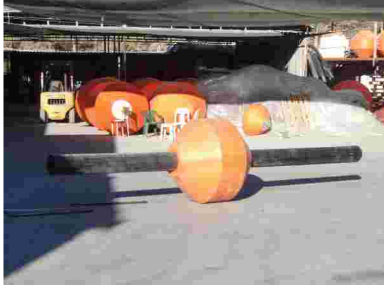
Sekil.3 Yüzen Yapay Resif Yapiminda Kullanilan Malzemeler
