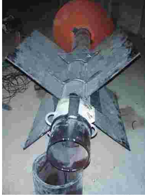
Şekil.5 Yüzen Yapay Resiflerin Cezp edici Bölümü ve Bağlantı Düzenegi
