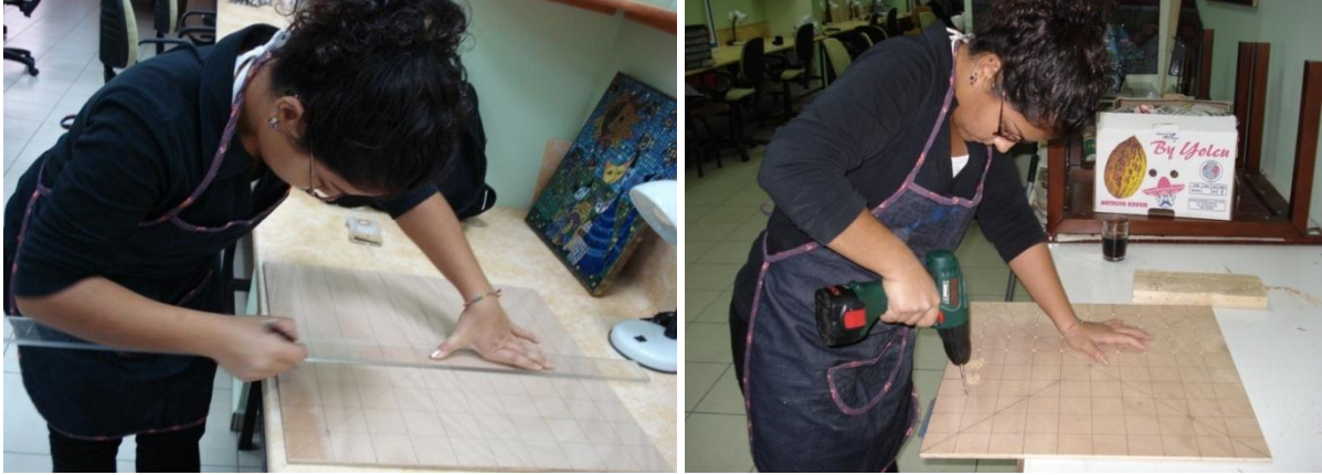
Resim 5: Ahşap plaka üzerinde delik yerlerinin belirlenmesi ve delme işlemi
