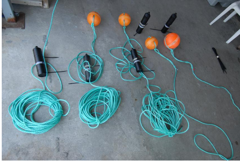
Şekil. 8 VPS Sistemini Meydana Getiren Alıcılar ve Demirleme Sistemi
